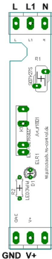
Steuerspannung: 12V(9 bis 14V) DC (5V bei Option L)
