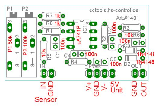
Hinweis für den Betrieb mit dem AD-Multiplexer(und CC2-ReglerBoard): Auf der Platine sollte R4 nicht bestückt werden.
