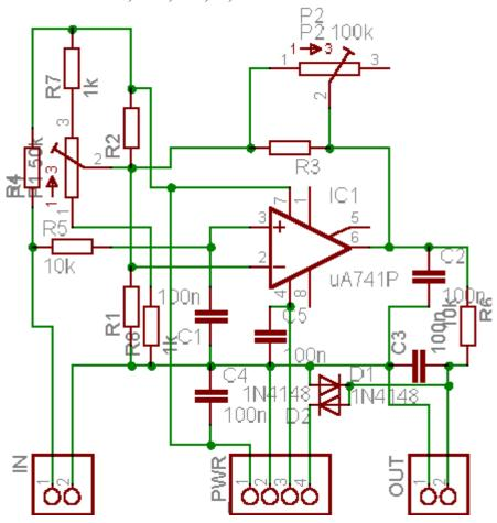
Mit dieser Platine können PTC-Temperatursensoren ausgewertet werden.(z.B. KTY10,KTY81)
