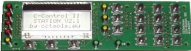
Das CC2-Station IO2 ist ein Bedienelement zur Advanced CC2-Station V2.
