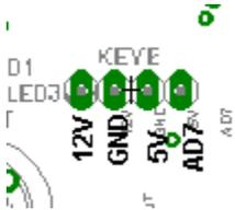
Rechts oberhalb des HOST-Tasters befindet sich ein 4pol. Anschluß für ein Tastatur-Interface an AD-Port 7.
