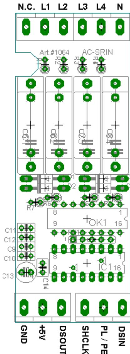
Steuerspannung: 5V DC (stabilisiert)
