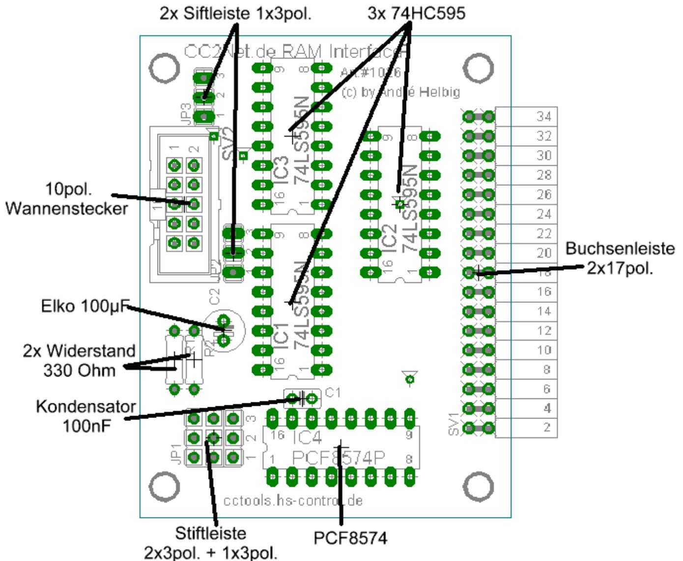
Wahlweise kann eine gerade oder abgewinkelte 2x17 pol. Stiftleiste bestückt werden. Bei der Bestückung mit einer **geraden** Stiftleiste zur Sandwichmontage, muß diese auf der **Lötseite bestückt** und auf der **Bestückungsseite verlötet** werden !!
