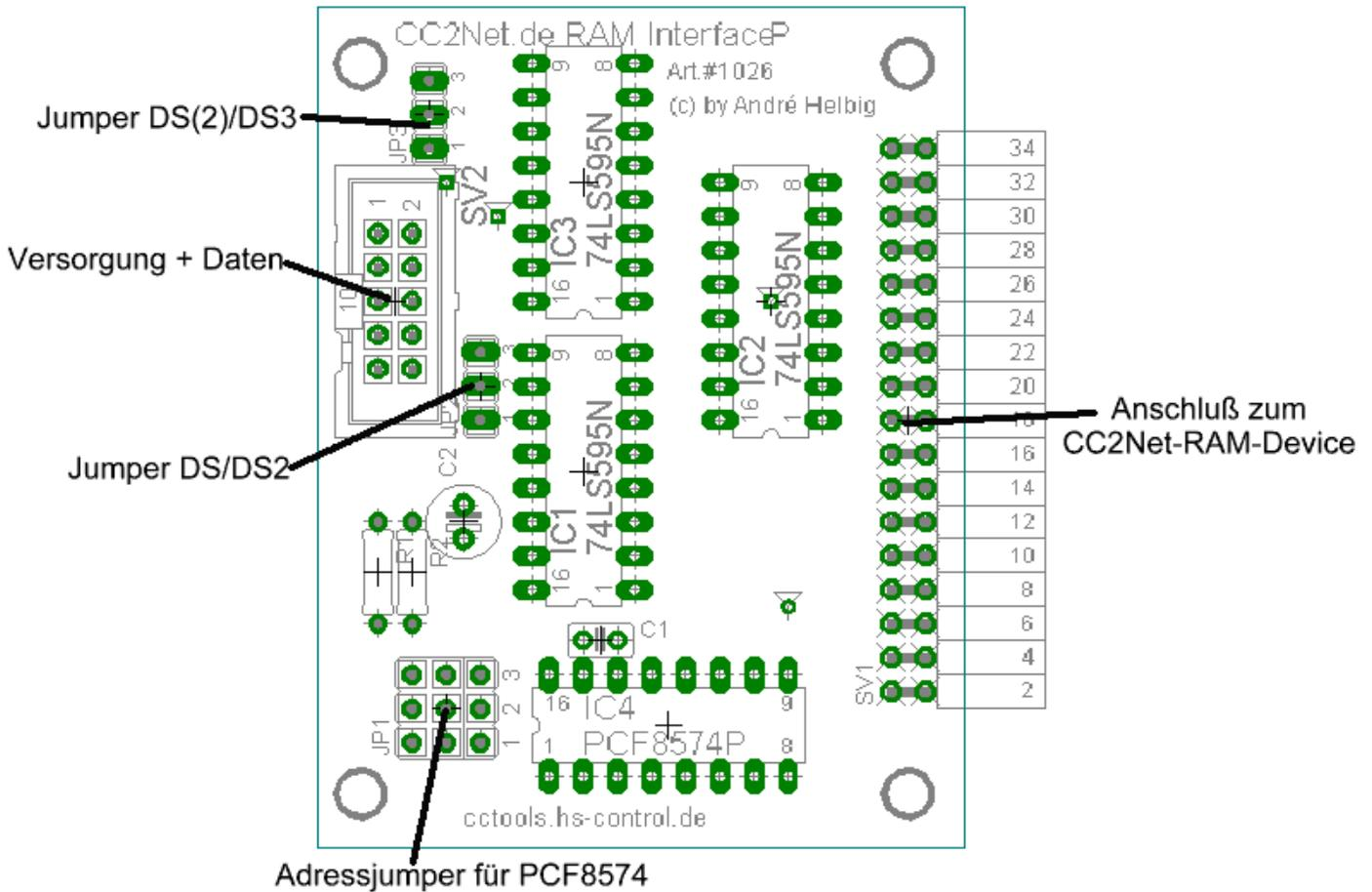
Das CC2Net-RAM-Interface benötigt mind. 4 I/O-Ports und den I<sup>2</sup>C-Bus. Um die max. mögliche Geschwindigkeit zu erhöhen können bis zu 6 I/O-Ports benutzt werden. Standardmäßig befinden sich die die Jumper DS/DS2 und DS(2)/DS3 zwischen den Pins 2 und 3. Sollen 5 I/O-Ports benutzt werden wird “Jumper DS/DS2” auf die Position 1-2 gesetzt. Für 6 I/O-Port wird zusätzlich “Jumper DS(2)/DS3” auf 1-2 gesetzt.
