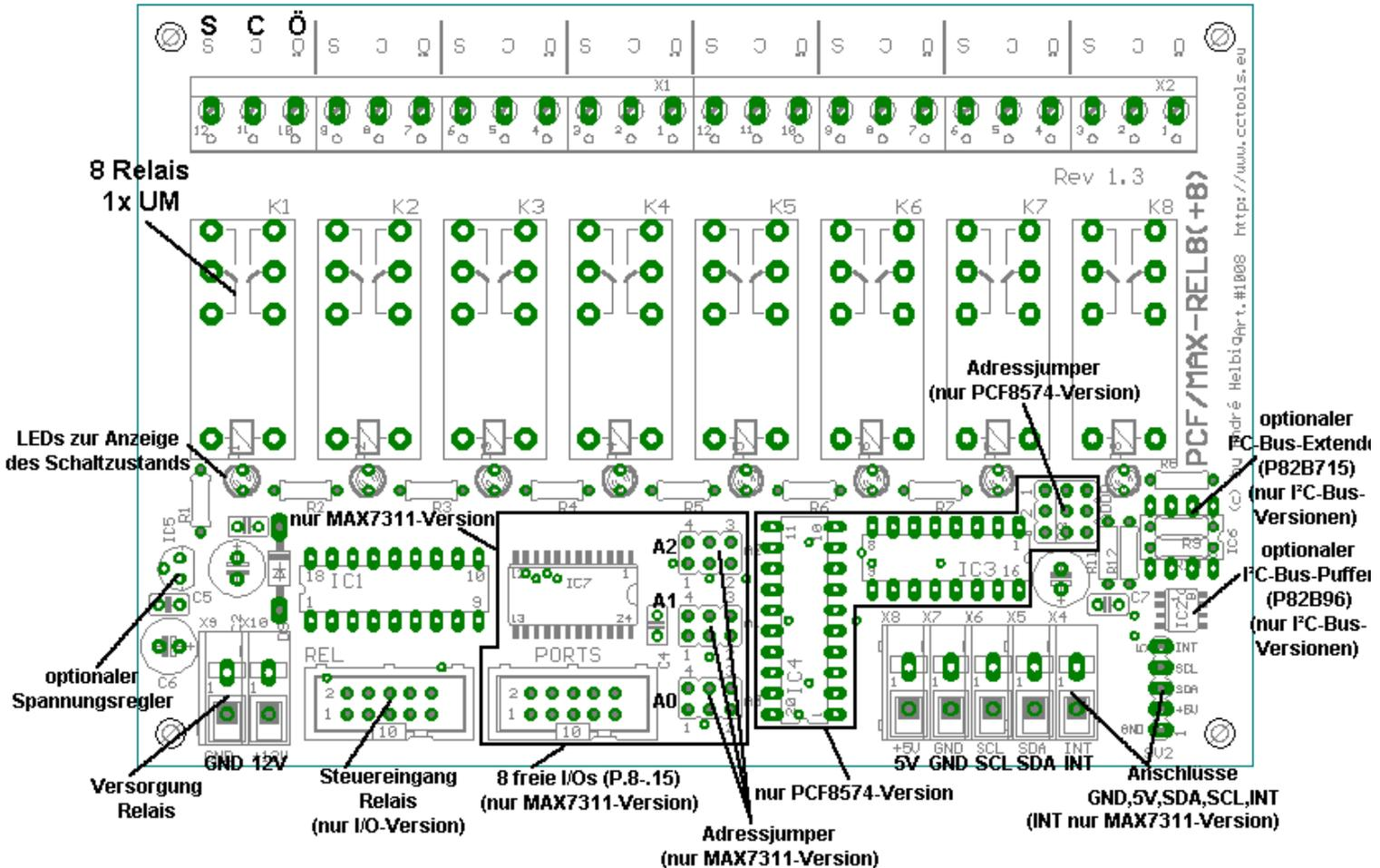
Die PCF/MAX-Rel8(+8)-Relaisplatine stellt 8 Relais mit Umschaltkontakten zur Verfügung.
