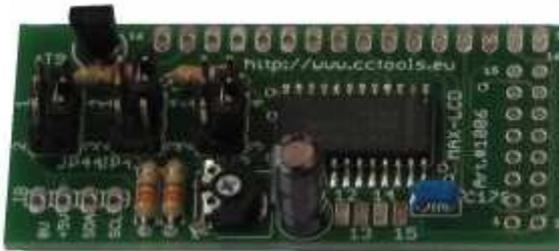
Das MAX-LCD ermöglicht den Anschluß von Standard-LCDs an den I<sup>2</sup>C-Bus. Das Display wird über den 16-Bit Portexpander MAX7311 angesteuert. Durch den MAX7311 sind bis zu 64 unterschiedliche Adressen nutzbar. Eine Treiberschaltung für die Beleuchtung von LCDs ist bereits auf der Platine integriert.
