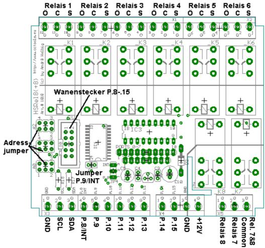
Die HSRel8(+8) ist eine 8-fach-Relaisplatine für Hutschienengehäuse mit 6TE.
