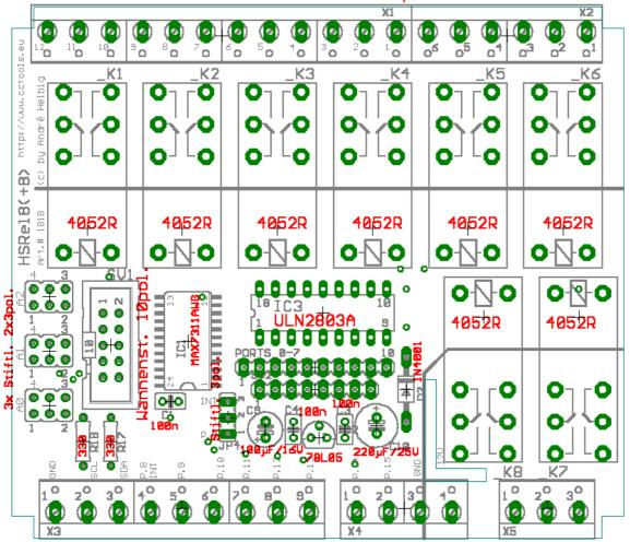
3x Schraubklemme 3pol. 2x Schraubklemme 2pol. + 1x 3pol.
