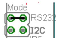
Die Adresse des eDIP im I<sup>2</sup>C-Modus wird über Jumper eingestellt. Es sind dabei bis zu 64 Adressen möglich. Im RS232-Modus wird über Jumper die Baudrate festgelegt.
